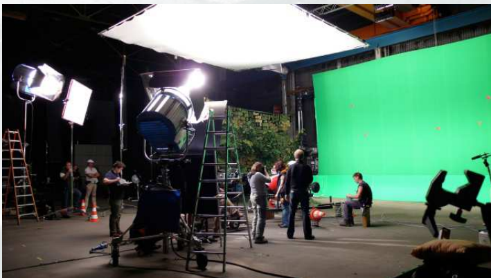
Links: Traditionelle Filmset mit HMI Fresnel-Lampen und große Diffusionsstoffe
